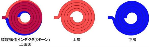
螺旋構造インダクタ(8ターン) 上面図
